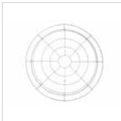
60605 Grille de protection en acier galvanisé et peint couleur Argent. Rejilla de protección en acero galvanizado y barnizado Silver.
