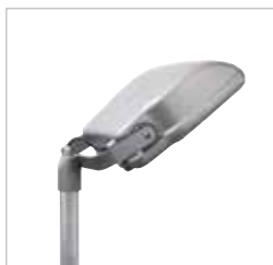
AKRON 1 60235 Pour montage d'un seul appareil en tête de mât Ø = 60 mm. Il est constitué d'un manchon simple en fonte d'aluminium moulé sous pression, peint de couleur argent.
