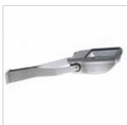
AKRON 1 60235 Pour montage d'un seul appareil en tête de mât Ø = 60 mm. Il est constitué d'un manchon simple en fonte d'aluminium moulé sous pression, peint de couleur argent.
